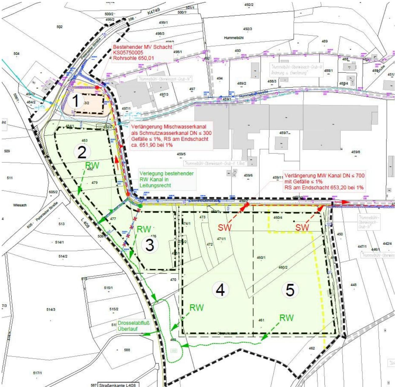
Abb. V-1: Systemkonzept Entwässerung (Vorentwurf)
